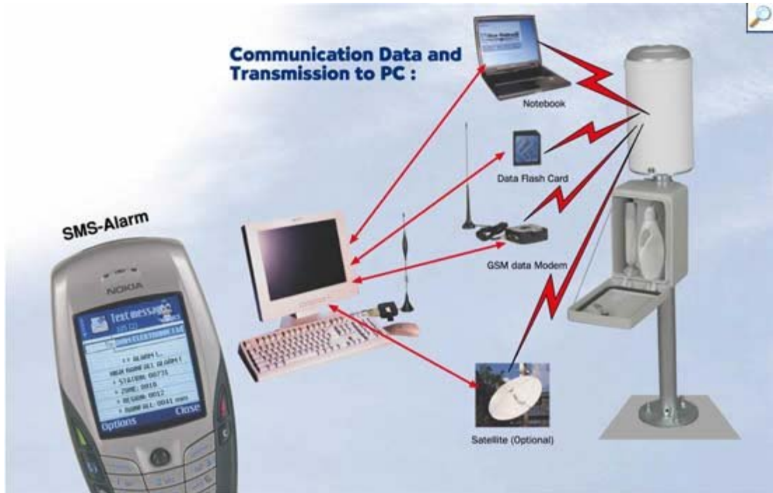
Şekil-1 Yeni nesil Plüviograf İletişim üniteleri sistemi.
